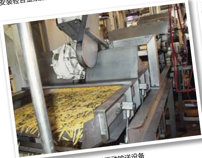
安装焊接式不锈钢摇臂的食品振动输送设备
