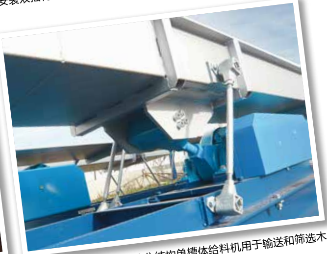
安装双摇臂AD-P 50的双质体振动給料设备用于输送松散物料
