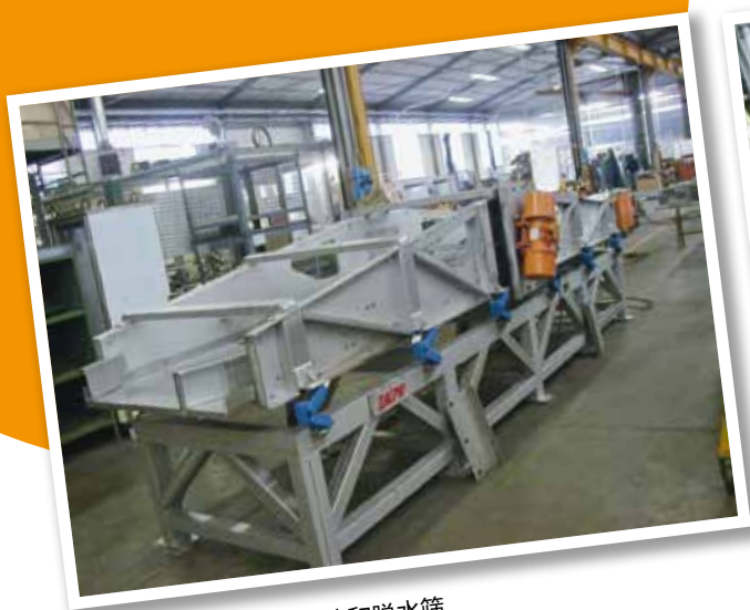
AB型支撑用于蔬菜的清洗和脱水筛
