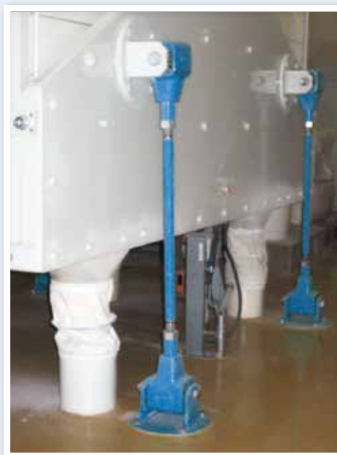
自由激振驱动的面粉回转筛安装8只AV 38弹性接头
