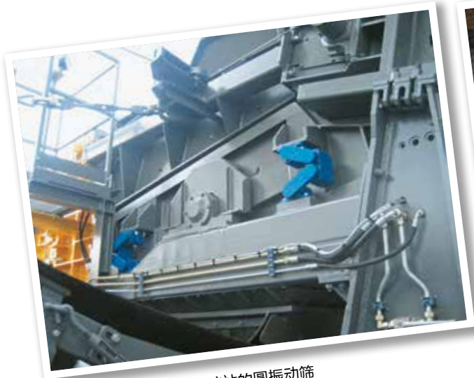
AB 型支撑用于移动式破碎站的圆振动筛
