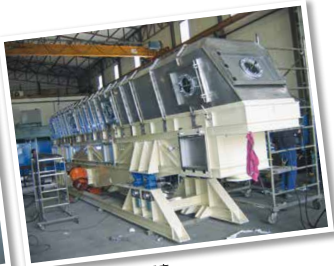
AB-D 型支撑用于硫化干燥床
