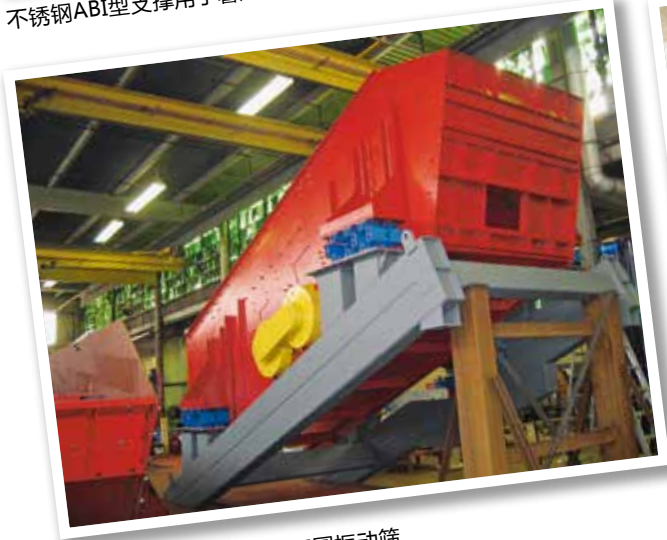
AB TWIN型支撑用于矿用圆振动筛
